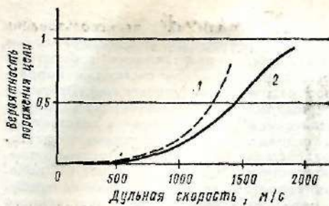
Рис. 3. Зависимость вероятности поражения цели от дульной скорости снаряда: 1 — вероятность поражения примерно пропорциональна четвертой степени дульной скорости; 2 — размер цели 3×3 м, дальность стрельбы 2000 м, 50 снарядов в очереди
